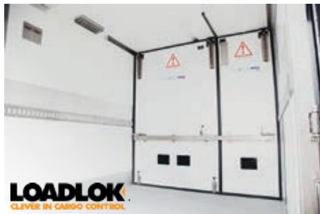
et coulissement SmartLift permet un positionnement facile et rapide de cette cloison sur la longueur de la remorque et offre la plus faible restriction de hauteur (110 mm). L'ergonomie de notre nouveau système de verrouillage intégré à la trappe de décompression facilite l'ouverture et offre une rapidité répondant aux demandes les plus exigeantes tel que le transport pharmaceutique.
